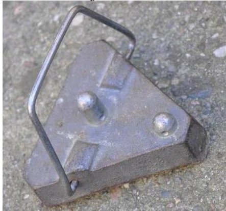
Slika 25. Nivelmanska papuča sa dva repera
